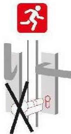
In Antipanik-Schlösser dürfen keine Schließzylinder mit Freilauffunktion des Mitnehmers und keine Knäufzylinder eingebaut werden. Der Schlüssel darf bei diesen Schlössern grundsätzlich nicht im Schloss verbleiben.
