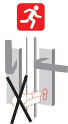
Bei Schlössern mit einer Anti-Panik Funktion dürfen keine Freilaufzylinder wie z.B. Knaufzylinder verwendet werden.
