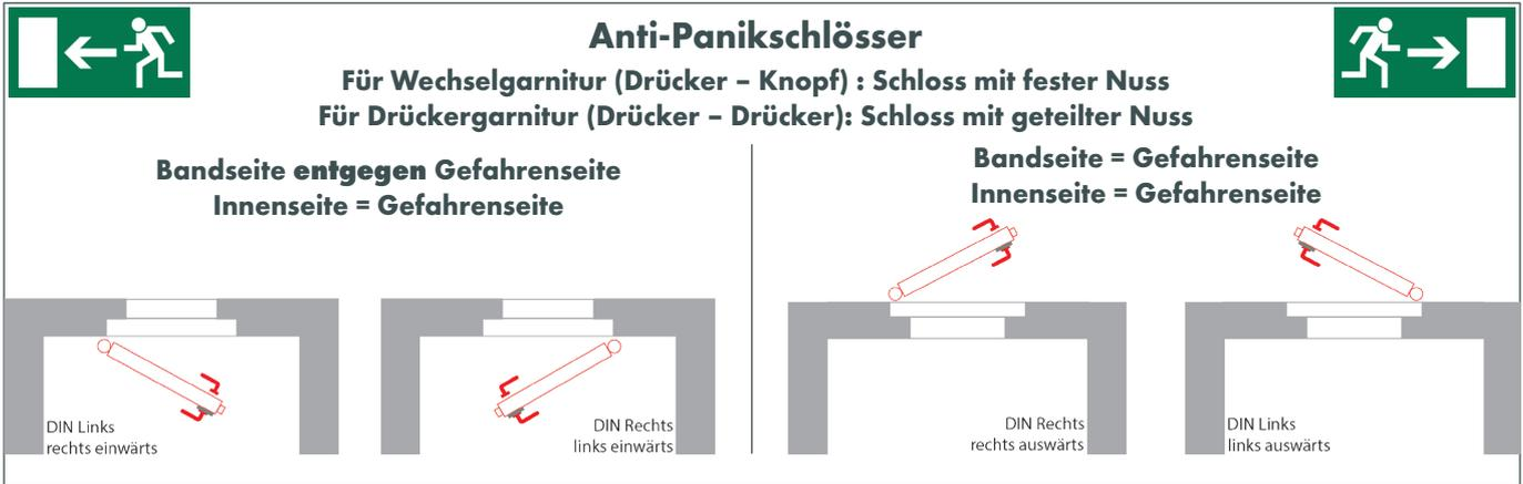
**260 P PF**, Korridorürschloss, mit Anti-Panikfunktion E, mit 9 mm fester Nuss für Wechselgarnitur (Drücker/Knopf), mit Wechsel
