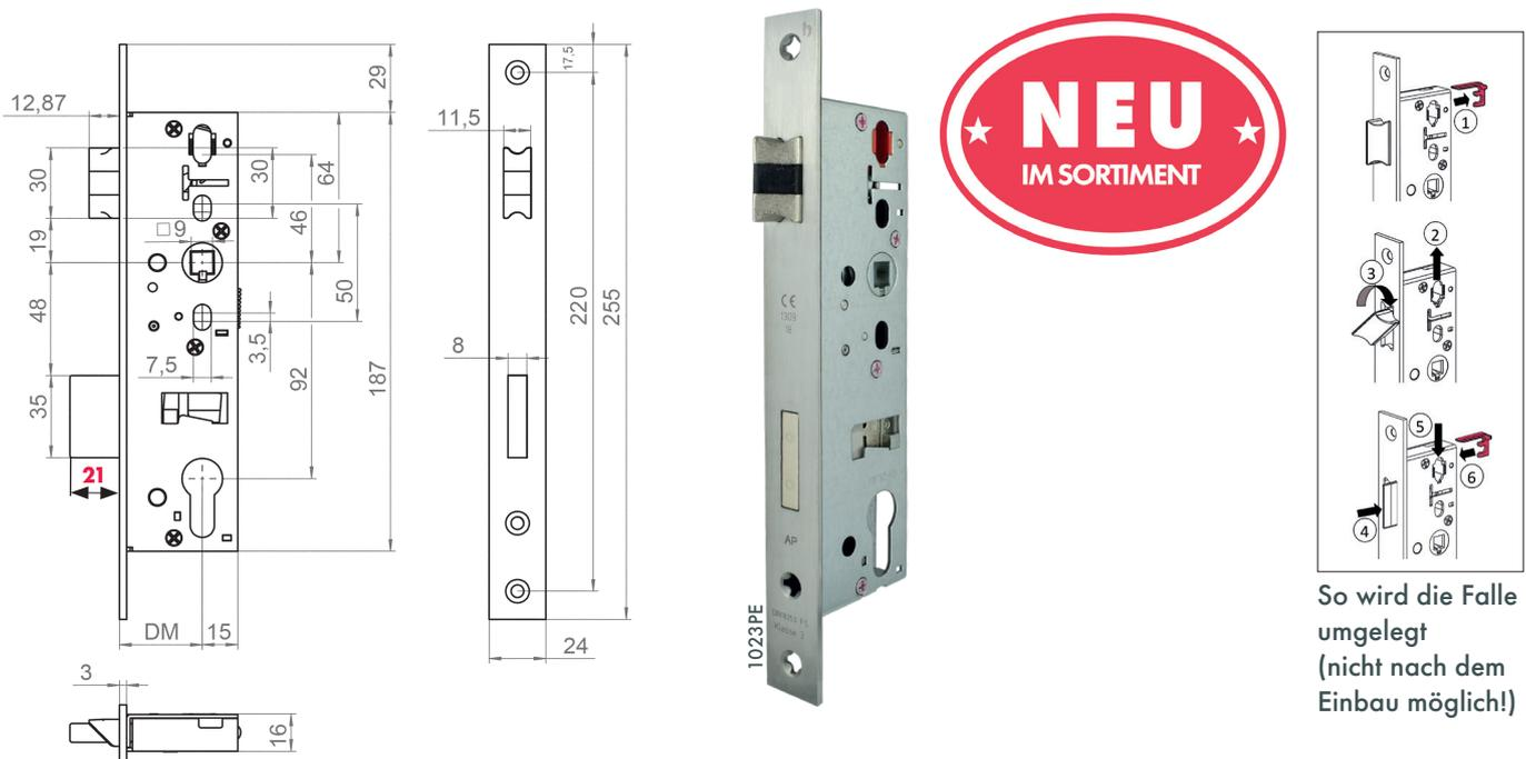
So wird die Falle umgelegt (nicht nach dem Einbau möglich!)
