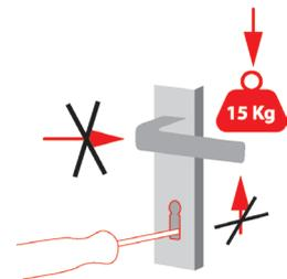
Der Drücker darf nur in Betätigungsrichtung mit maximal 150 N verwendet werden. Das Schloss darf nicht mit artfremden Gegenständen geöffnet werden.
