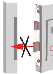
Das Schloss darf nicht bei ausgefahrenem Schlossriegel verschlossen werden.
