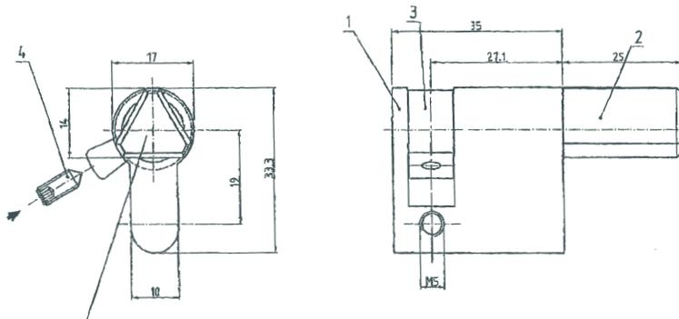
Dreikant passend für Steckschlüssel M10 nach DIN 22417
