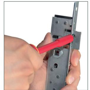
So wird die Falle umgelegt (auch nach Einbau möglich!)
