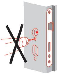
Das Türblatt darf nach dem Einbau des Schlosses nicht durchbohrt werden.
