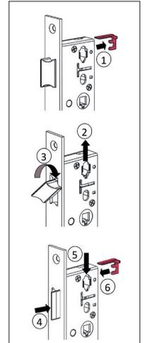
So wird die Falle umgelegt (nicht nach Einbau möglich!)
