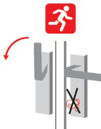
Bei Schlössern mit einer Anti-Panik Funktion darf kein Schlüssel im Schloss stecken bleiben.
