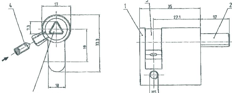
Dreikant passend für Steckschlüssel M5 nach DIN 22417
